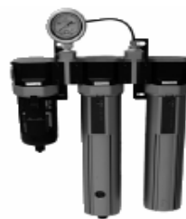
Druckluftmembrane Diese Option wird benötigt, wenn die Spezifikationen für die erforderliche Druckluft nicht eingehalten werden können. Die Membrane reduziert den Taupunkt auf die erforderliche Spezifikation. Inklusive Filter.
